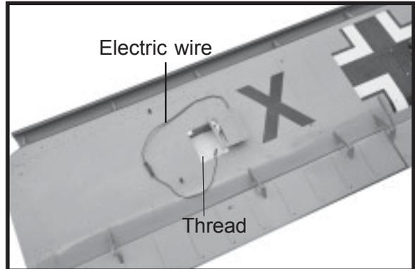
**3.INSTALLING THE AILERON LINKAGES.**
